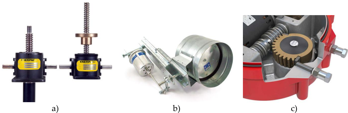
Slika 1.9. Mehanički pretvarač rotacionog u linearno kretanje (a), linearnog u oscilatorno kretanje (b) i rotacionog u rotaciono kretanje uz povećanje obrtnog momenta (c)
